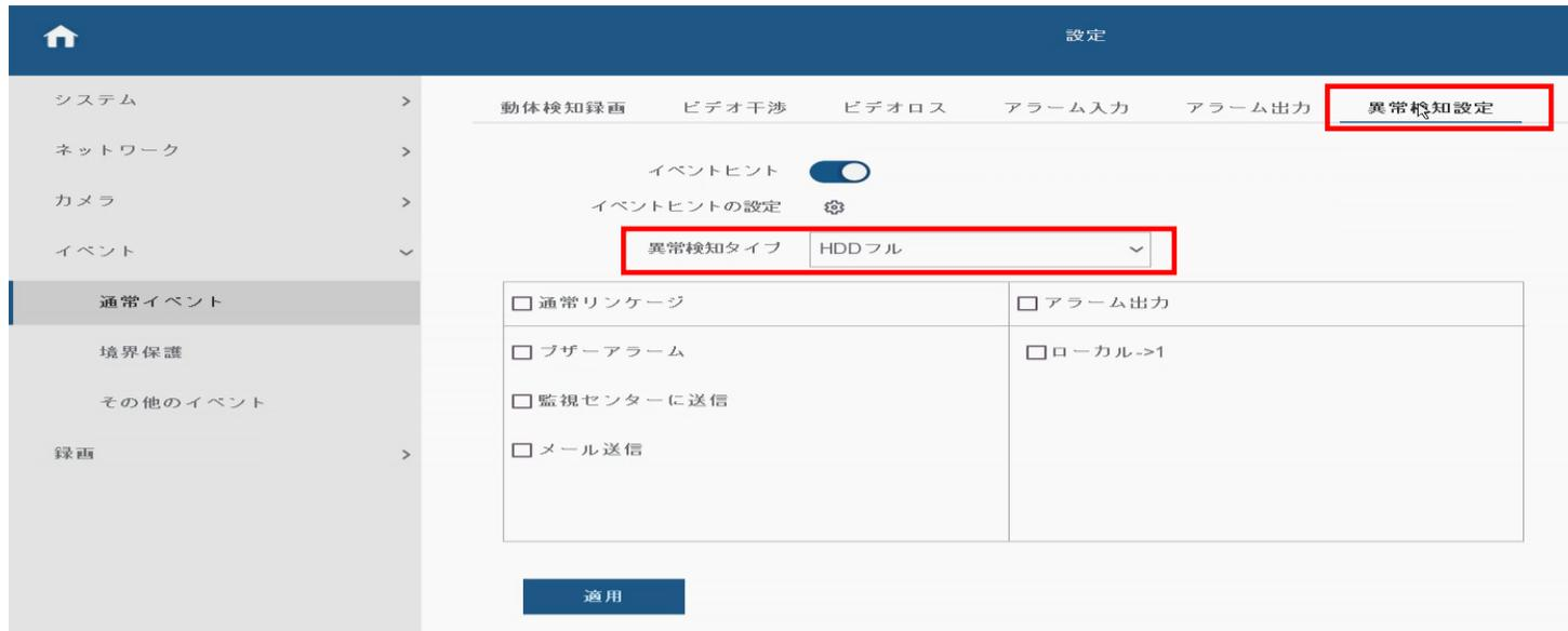
②異常検知タイプを「HDDエラー」にして【ブザーアラーム】のチェックを外して適用をクリックする
