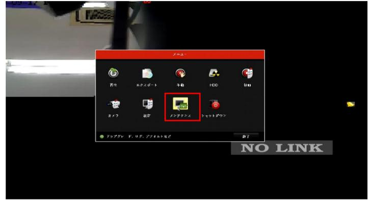
[HDDの検出]-[不良セクタ検出]-[キーエリア検知]-[検出]をクリックする
