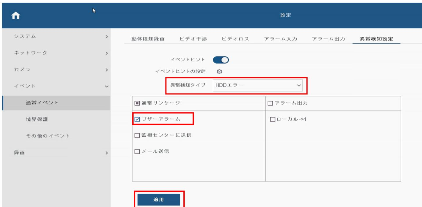
③異常検知タイプを「録画失敗」にして【ブザーアラーム】のチェックを外して適用をクリックする
