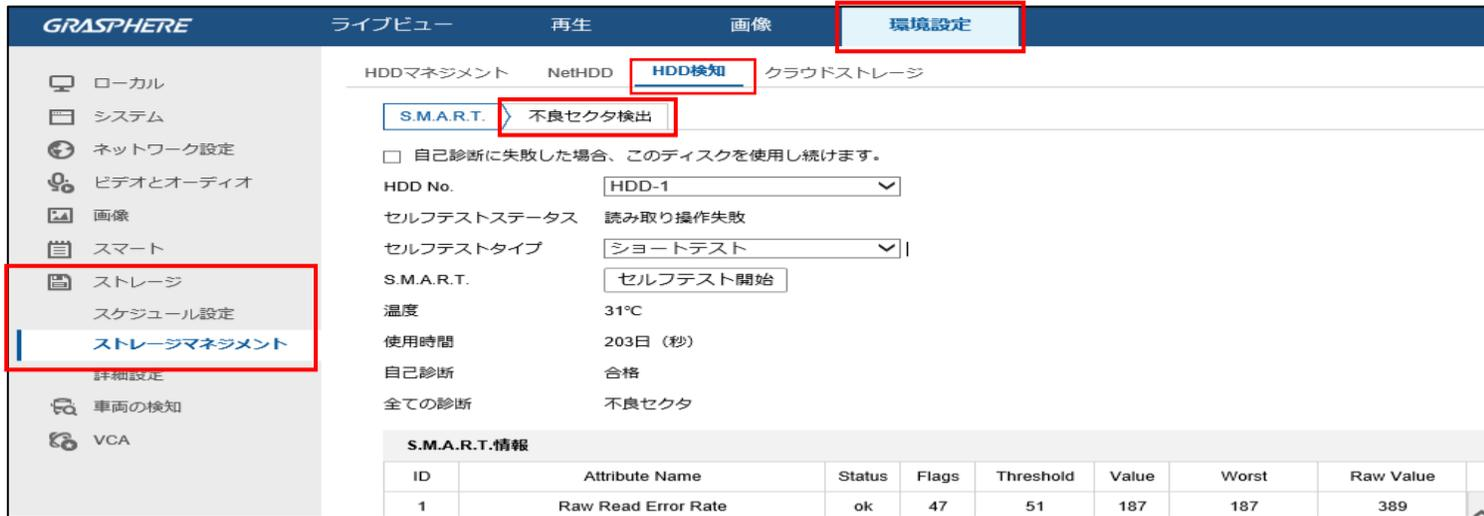
【HDD No】を選び【キーエリア検知】にして【検測開始】をクリックする
