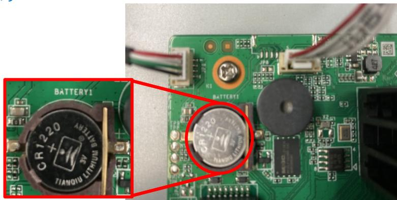
②基板に「コイン型(ボタン)電池」が実装されている状態で電圧が3V以下の場合は交換してください。
