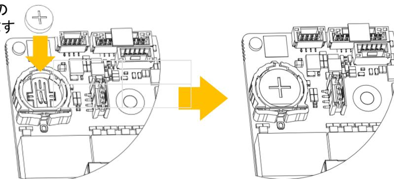
ボタン電池交換後に、基板実装された状態で電圧が3.0V以下で無いことを確認して交換完了です
