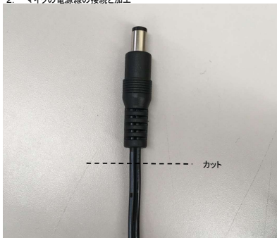
(1) DC12Vアダプタにプラグが付いている場合はカットします。
