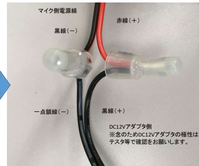
(3) DC12Vアダプタとマイクの電源線を圧着します。
