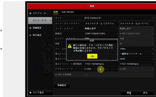
メインおよびサブの[ストリームタイプ]切り替え時は、必ず対象カメラの再起動が行われます。
