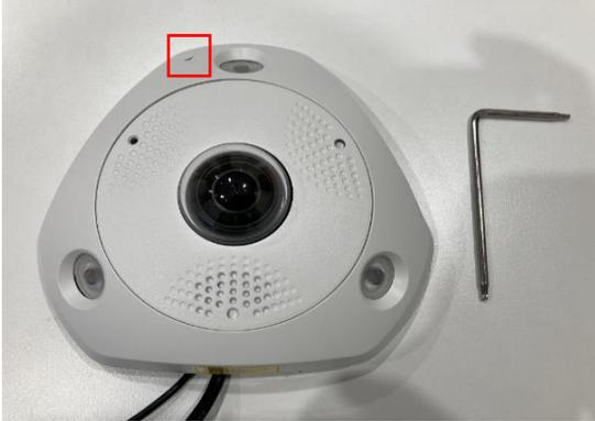
② ①のアカ枠のところにカバーがあるのでカバーを開けてトルクスネジを緩める
