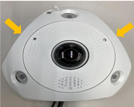
④ アカ枠で囲まれたトルクスネジ2本を緩めmicroSDカードのカバーを外す
