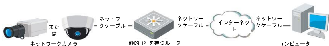
図 16-10 静的 IP を持つルータを経由したカメラへのアクセス
