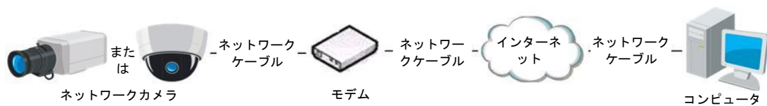
図 16-12 動的 IP を持つカメラによるアクセス
