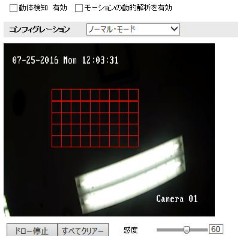
図 23-1 動体検知の有効化
