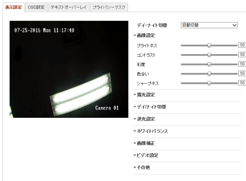
図 22-1 日中/夜間自動切り替えの表示設定
