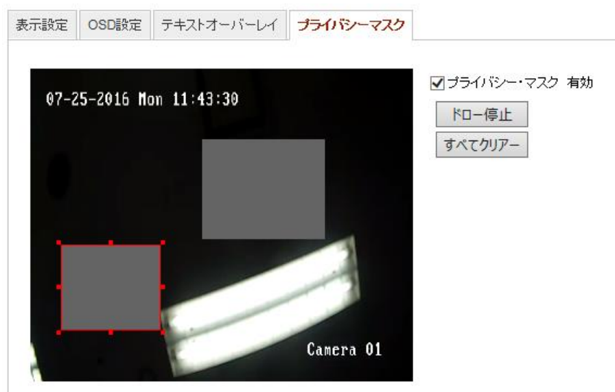
図 22-7 プライバシーマスク設定
