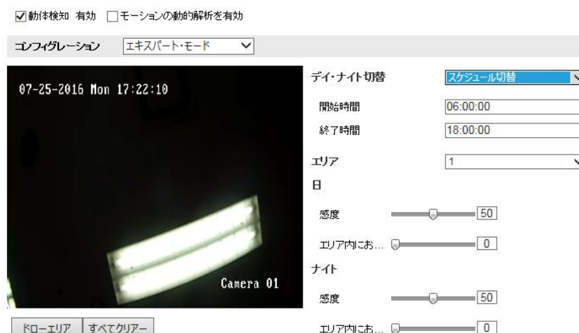
図 23-5 動体検知のエキスパートモード
