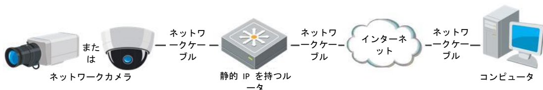
図 2-10 固定 IP を持つルータを経由したカメラへのアクセス
