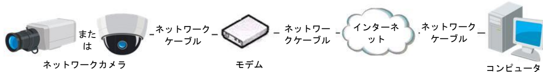
図 2-12 動的 IP を持つカメラによるアクセス
