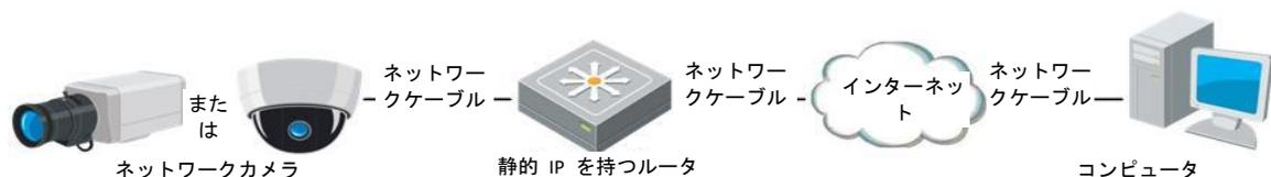
図 2-10 静的 IP を持つルータを経由したカメラへのアクセス
