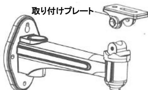
図 2-4 取り付け板の分解
