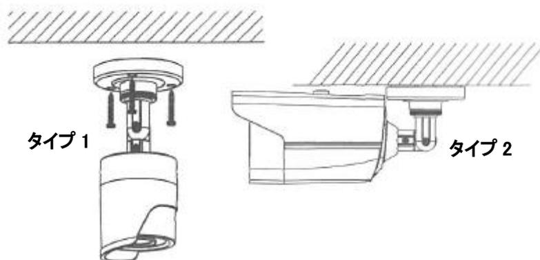
図 2-2 カメラを天井に固定する
